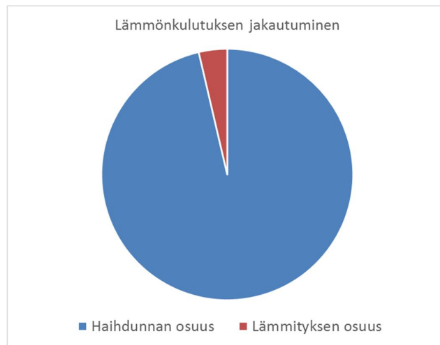
Kuva 31. Allasveden haihdunnan ja haihtuvan vesimäärän lämmityksen lämmitysenergian kulutus
