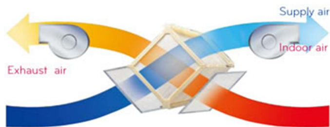
Kuva 27. Lämmön talteenoton perusperiaate. Lähde http://www.easicooling.co.uk/images/other/Heat%20Recovery%20Diagram.jpg
